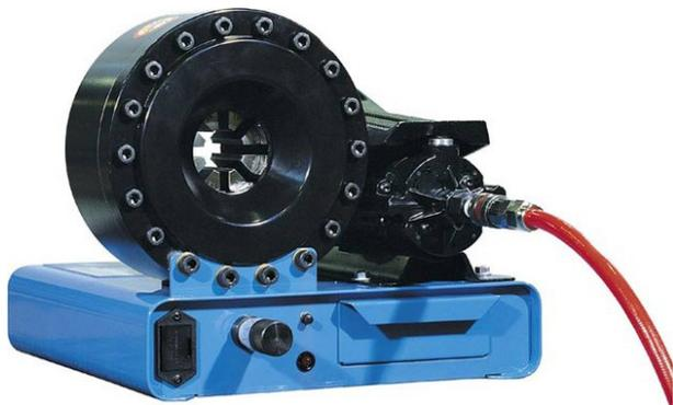
El modelo P16 AP de Finn-Power es una maquina de prensado que funciona con aire comprimido.
